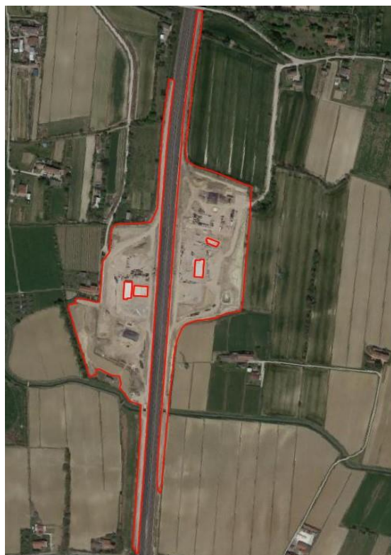
Figura 22. Esempio di consumo di suolo per la costruzione di aree di servizio dell'A27 a Casale sul Sile in provincia di Treviso tra il 2019 e il 2020; l'area di cantiere è di circa 10,9 ettari
