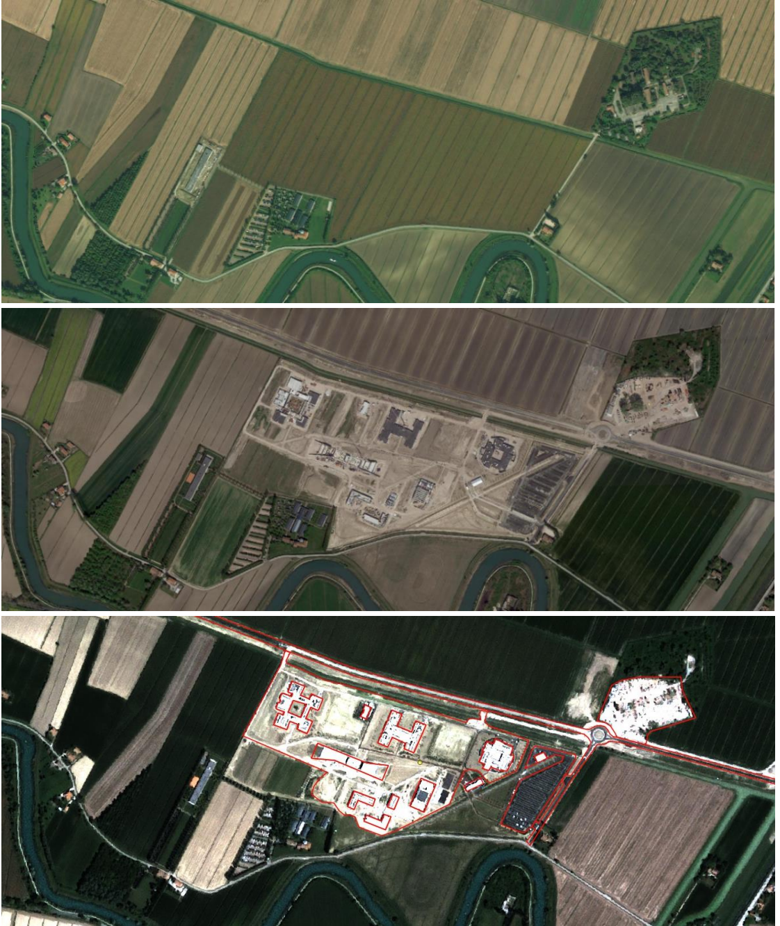
Figura 8. Realizzazione di un nuovo campus a Roncade (Treviso) su un'area di cantiere di 35 ettari, ex area agricola., di cui 5,2 ettari destinati a nuova viabilità, 2 ettari a parcheggio e più di 3 ettari destinati a costruzioni con cubatura recuperata da una ex area militare limitrofa di 2,27 ettari (in alto a destra). Immagine 2018 in alto, 2020 al centro e in basso
